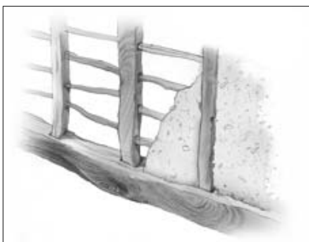
Figura 6.99. Recreación de la técnica constructiva del pans de bois (Dibujo DBOLIT).
