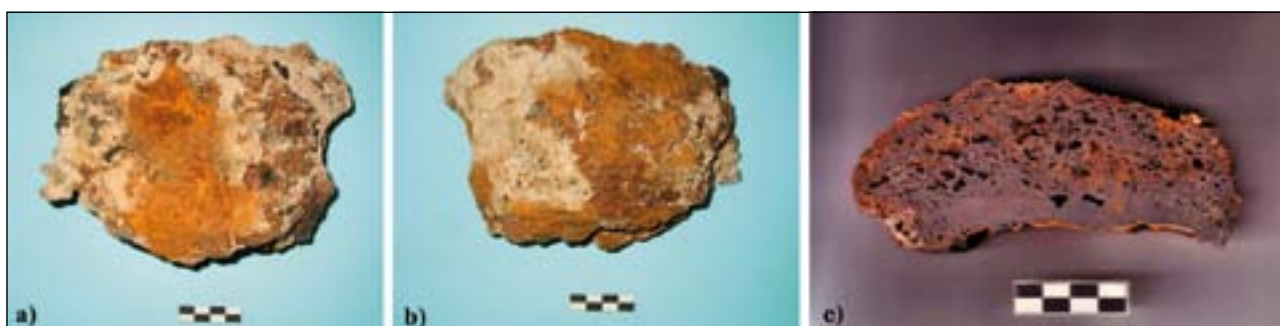
Figura 6.35. Escoria SMC.18171-1: a) cara superior; b) cara inferior; c) macrografía de la sección.
