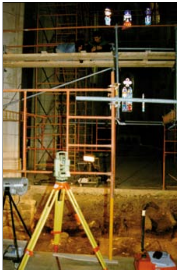
Figura 4.13. Toma de pares fotogramétricos durante las excavaciones de 1997.
