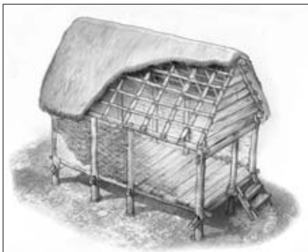
Figura 6.87. Recreación de la estructura portante del granero A4 (Dibujo DBOLIT).
