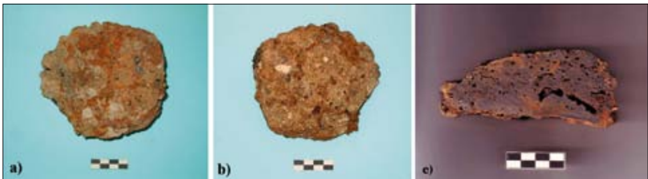
Figura 6.32. Escoria SMC.24115-41: a) cara superior; b) cara inferior; c) macrografía de la sección.
